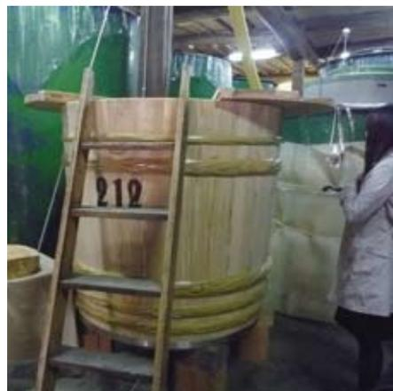
写真4 吉野杉で新調された醸造用の桶（吉野町 美吉野醸造）
